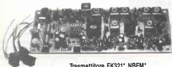
Trasmittitore FK321* NBFM* Gamma VHF amatori 144-148 MHz* Gamma VHF marina/privati 150-170 MHz
